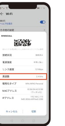
現在のWi-Fi周波数を確認できない場合、ルーターのゲートウェイアドレスにログインして、Wi-Fiルーターのチャンネル設定を変更するには、Wi-Fiを確認して2.4GHzに設定してください（ゲートウェイアドレスは通常、ルーターの背面のラベルに記載されています）。
